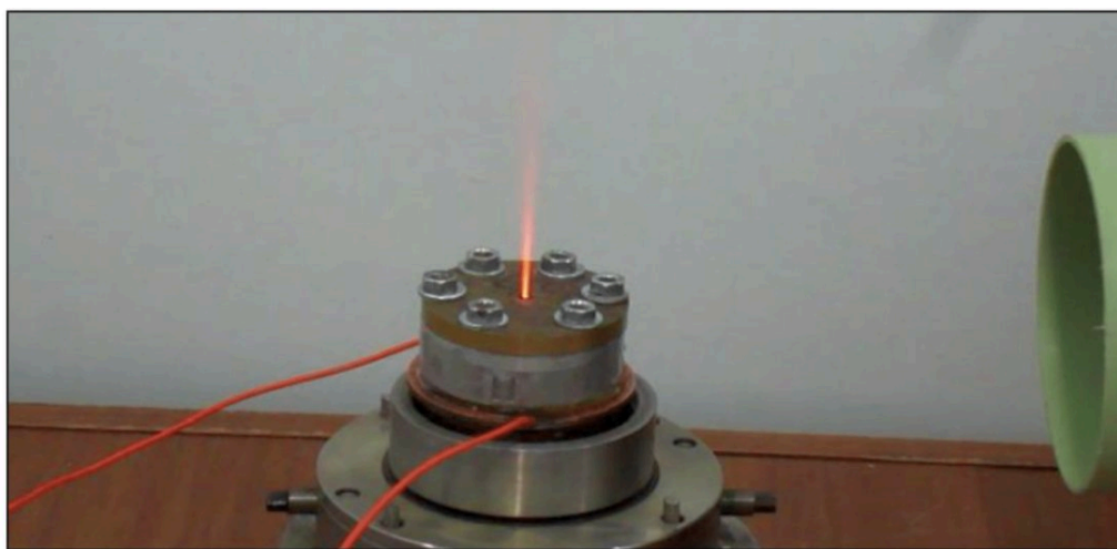
Рисунок 18 – Лабораторное устройство для сжигания образцов
