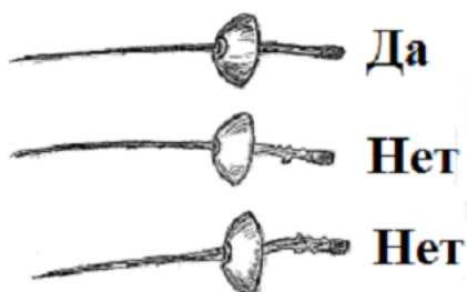
Рис. 7. Измерительное приспособление для проверки оружия
