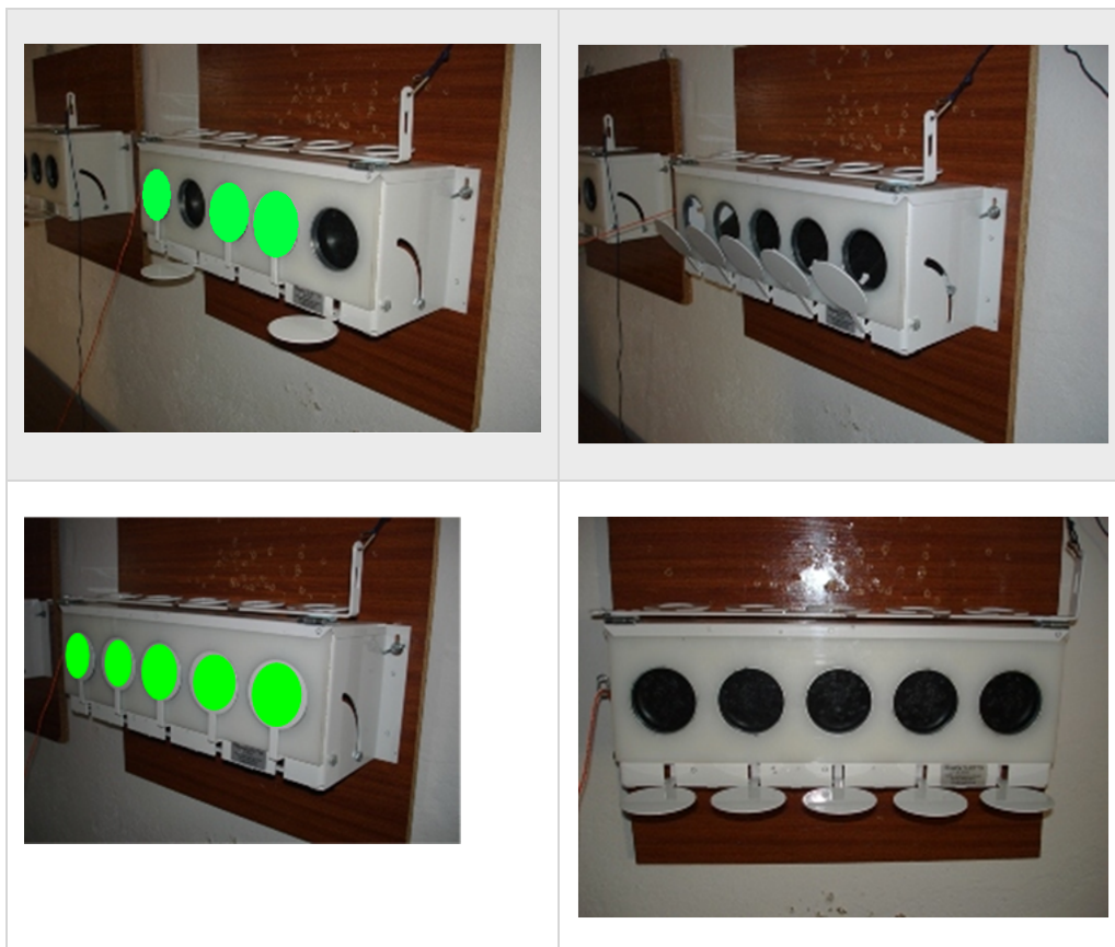
Рисунок 7. Электронная мишень для стрельбы с пулькой
