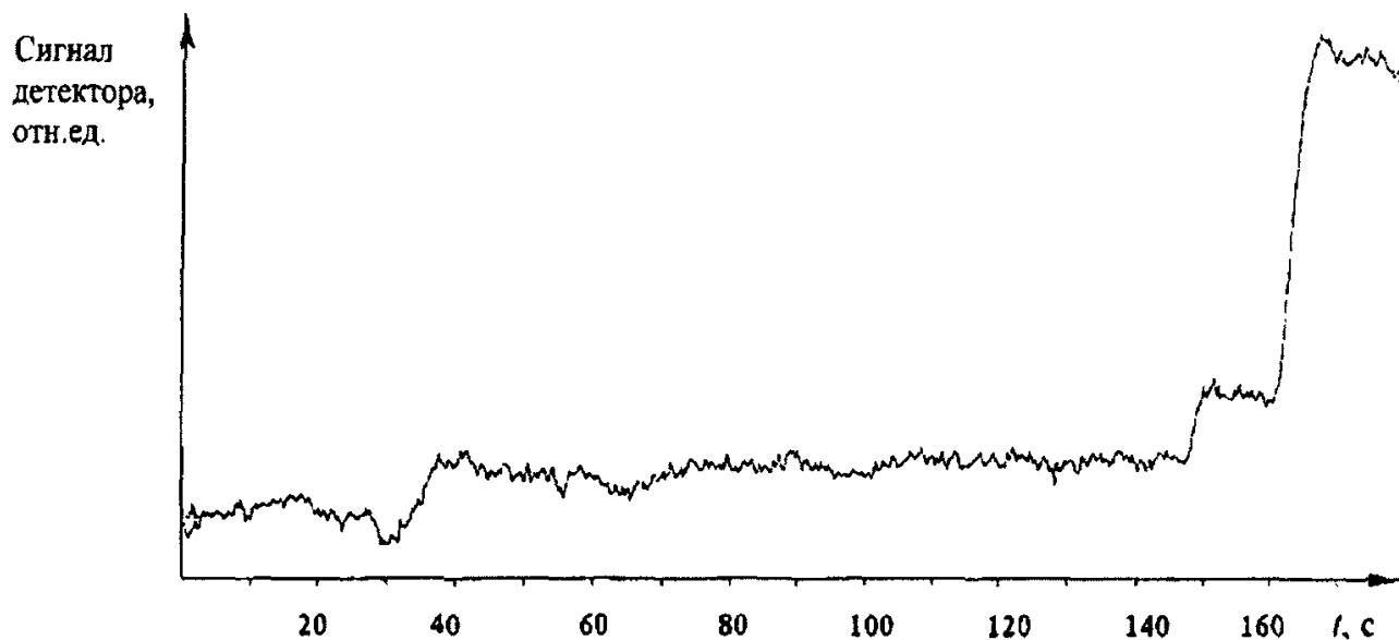
Рисунок Б.3. Электрофореграмма сточной воды без отгонки
